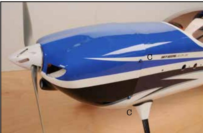
5) Retirer le capot, puis les scotchs. Fixer le contrôleur sous le plancher derrière le moteur après avoir vérifié le sens de rotation du moteur puis repositionner le capot et visser. Monter hélice et cône.
