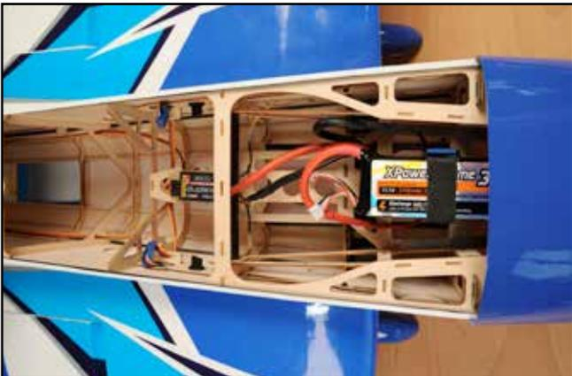
10) En fonction du centrage, positionner les accus et les maintenir en place à l'aide de Velcro® et sangle Velcro®.
