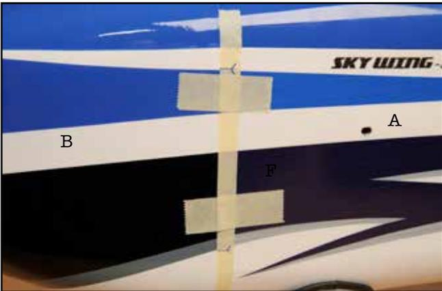
4) Présenter le capot sur le fuselage, enfiler le flasque du cône sur l'axe d'hélice et maintenez le capot en place à l'aide de scotch papier après avoir repéré les axes des vis de fixation du capot. Percer les trous de fixation.
