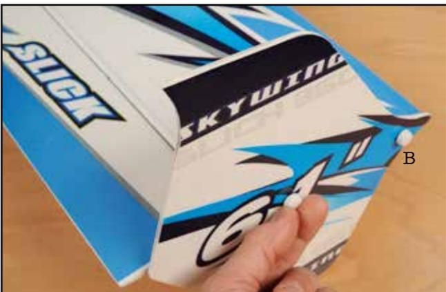
1) Visser les SFG en bout d'aile à l'aide des vis spéciales.
