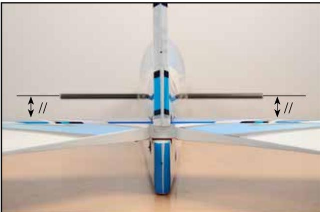
5) ... sans attendre, contrôler le parallélisme avec l'aile (ou la clé d'aile). Essayez les bavures de colle avant séchage.
