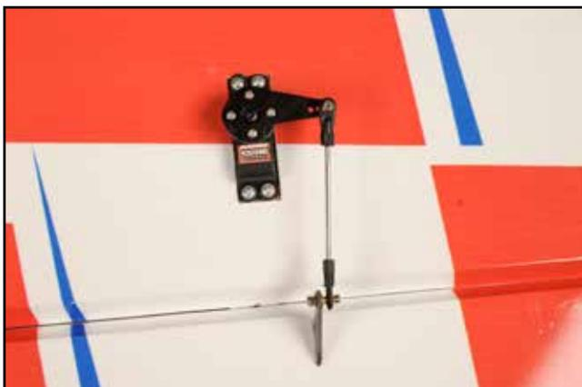
6) Notez que la tringlerie est parfaitement d'équerre au palonnier du servo et la connection au guignol dans l'axe des charnières.
