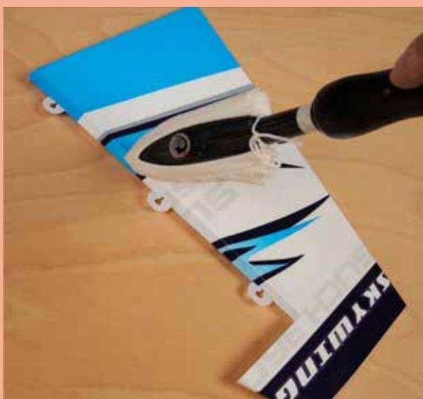
2) En utilisant un fer à solar et un chiffon doux, "repassez" délicatement et "suivez" en appliquant le film avec le chiffon. Si des bulles apparaissent, votre fer est peut être trop chaud. Réduire la température et travaillez doucement et patiemment.
