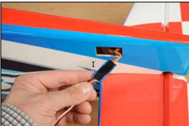
6) Connecter le servo de profondeur à sa rallonge, assurer avec la sécurité de connecteur fournie. Un tour de scotch crystal terminera de fiabiliser la liaison.
